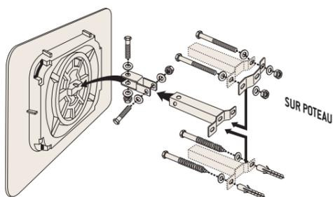
Livrée avec chaque miroir, fixation universelle pour murs et poteaux de 60 à 90 mm de section. Permet un réglage très précis de la position du miroir.
