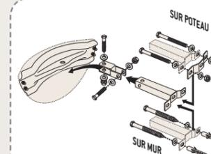
Livrée avec chaque miroir, fixation universelle pour murs et poteaux de 34 à 90 mm de section. Permet un réglage très précis de la position du miroir.
