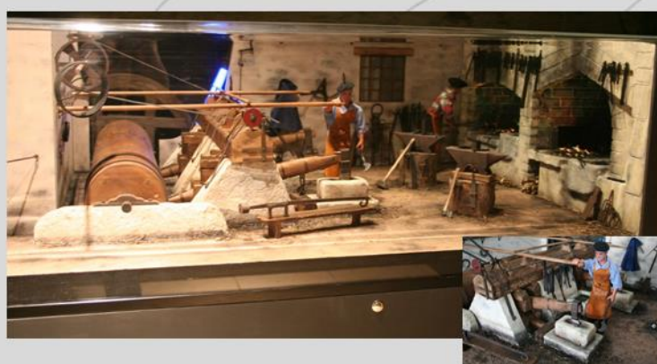
Reconstitution ancienne forge Taninges Maquette animée par automate, Lead (foyer), fibre optique (écoulement eau), moteur pour actionner la roue et enclencher le mouvement des marteaux. Echelle 1/5ème
