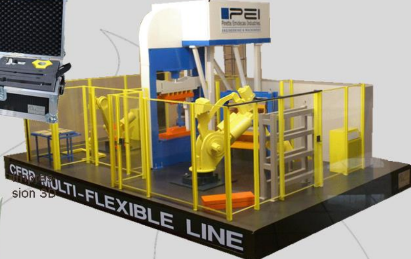
PINETTE PEI Chalon-sur-Saône Ligne de formage par compression pour pièces en carbone Echelle : 1/15ème
