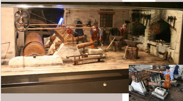
Reconstitution ancienne forge Tainings Maquette animée par automate, Lead (foyer), fibre optique (écoulement eau), moteur pour actionner la roue et enclencher le mouvement des marteaux. Echelle 1/5ème
