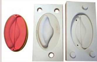
Prototype poignée pour handicapés SEVAX Groupe Saint Gobain Master et moule
