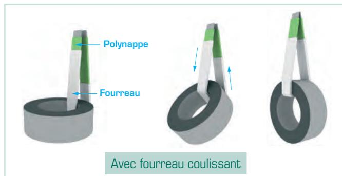
L'élingue POLYNAPPE, équipée d'un fourreau polyuréthane 2 faces, coulissant, devient alors particulièrement adaptée au levage de coils (voir schéma à droite). Le risque d'arrachement ou de détérioration de l'élingue au moment du levage est quasi nul : le fourreau coulissant permet de laisser glisser l'élingue et assure
