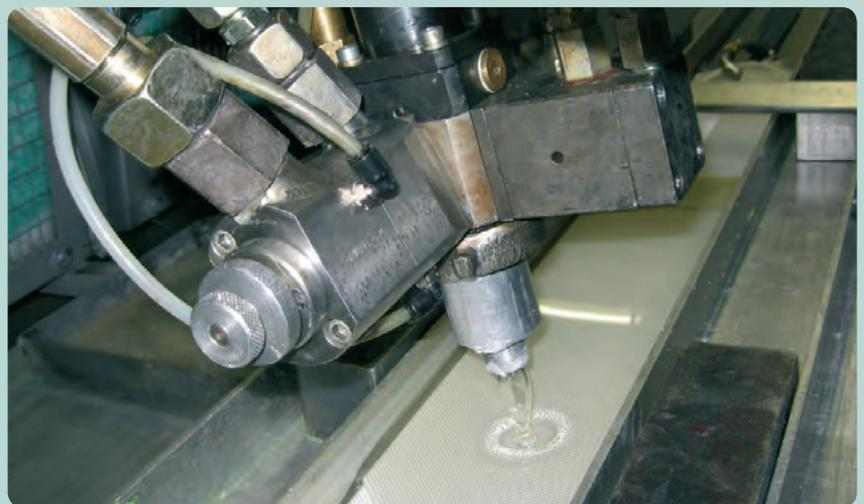
» Réalisation en cours d'un fourreau polyuréthane POLYSAFE 2 faces.
