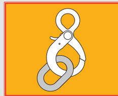
**Mailles de tête :** La maille de tête de l'élingue doit se placer facilement sur le crochet de l'appareil de levage et jouer sur celui-ci. Elle ne doit jamais se coincer sur le crochet. Protéger la maille contre les appuis sur arêtes vives et veiller à ce qu'elle ne subisse pas d'efforts de flexion.
