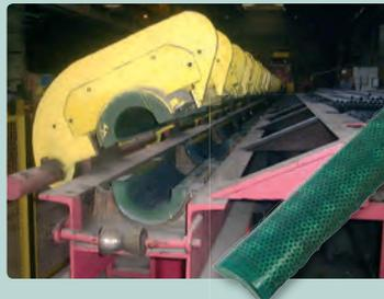
■ Le polyuréthane permet le remplacement d'une pièce à l'identique quand celle-ci devient introuvable sur le marché.
